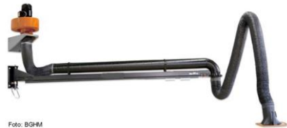
Stationäre Mitteldruckvakuumanlage incl. wandbefestigtem Galgen (bis zu 8 m Reichweite), Schlauchleitungen und Absaugelement für einen Arbeitsplatz, ohne Filterung wird abgesaugte Luft nach außen ins Freie geblasen
